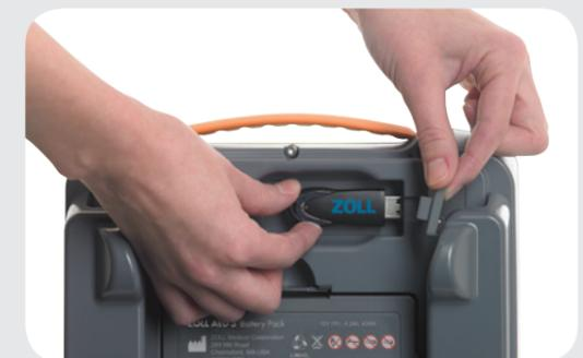
Stecken Sie einen Speicherstick in den USB-Anschluss, um Daten zu einem Rettungseinsatz herunterzuladen, eine neue Konfiguration hochzuladen oder ein Software-Upgrade durchzuführen.
