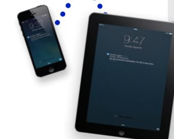
Sie konfigurieren den AED 3 für die Kontaktaufnahme mit PlusTrac in der Cloud nach jedem automatischen Selbsttest. Bei einem fehlgeschlagenen oder versäumten Selbsttest erhalten Sie sofort eine E-Mail, zusätzlich zu einem täglichen oder wöchentlichen Statusbericht.
